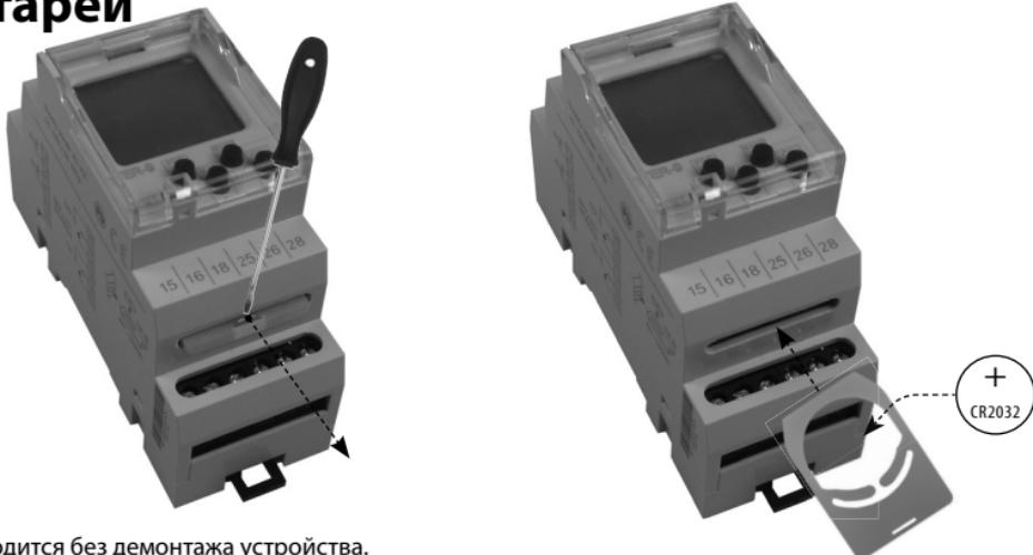
Замена батареи производится без демонтажа устройства.
