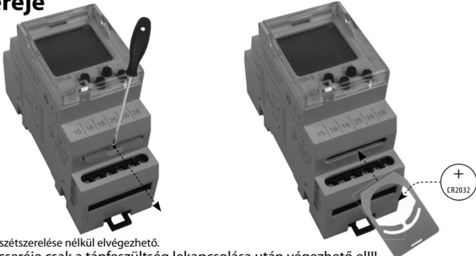
Az elem cseréje az eszköz szétszerelése nélkül elvégezhető.
