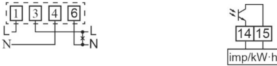
Рисунок Б. 1. Схема підключення лічильників до мережі споживача та нумерація контактів випробувального виводу
