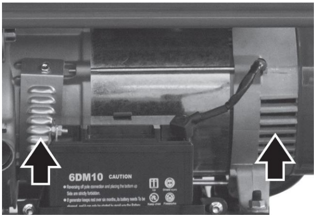
Впускні та випускні отвори охолоджувального повітря генератора змінного струму Загальне очищення генератора. Очистьте всі інші поверхні вологою ганчіркою.
