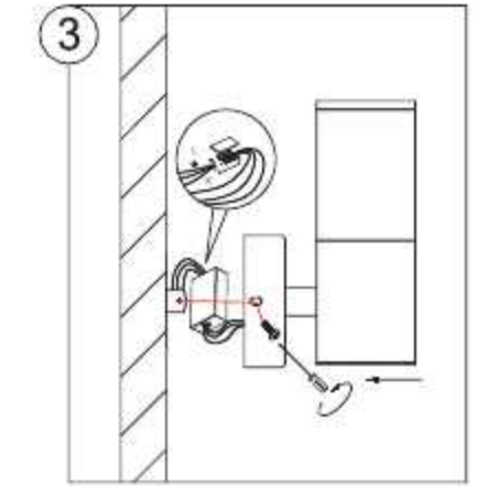
Підкрутіть два гвинти до корпусу світильника та пластини
