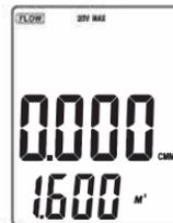
○ Наведите лопасти анемометра в зону воздуховода, для измерения 2/3 Vmax потока, нажмите "OPTION" для выхода из режима измерения 2/3 max,
