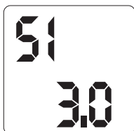
Якщо несправність надмірного струму триває 3 секунди, вихідне навантаження вимикається
