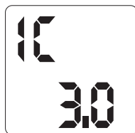
Зона спрацювання від перевантаження (межа чистої резистивного навантаження) 3 А
