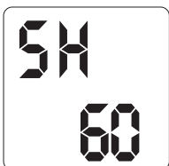
Затримка 60 с для відновлення живлення після спрацювання захисту від перевантаження
