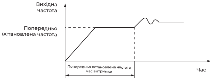
Рис. 3-2 Функція заповнення пустого трубопроводу
