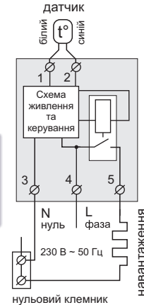
Схема 1. Спрощена внутрішня схема і схема підключення
